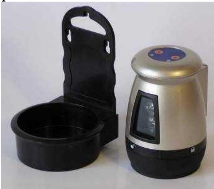
Лазерный построитель предназначен для отделочных и монтажных работ внутри помещений. Прибор обеспечивает построение одной вертикальной и одной горизонтальной плоскости. Оснащен компенсатором с магнитным демпфером. При отклонении свыше  $3,5^\circ$ , прибор сигнализирует о нарушении самовыравнивания
